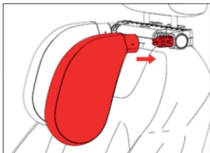
2. Nastavte posuvnú tyč do správnej polohy a nainštalujte ju na tyč opierky hlavy. Nainštalujte dve bočné podpery.
