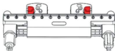
2. Wyregulować drążek przesuwny do odpowiedniej pozycji i zainstalować go na drążku zagłówka. Zamontować dwie podpórki boczne.
