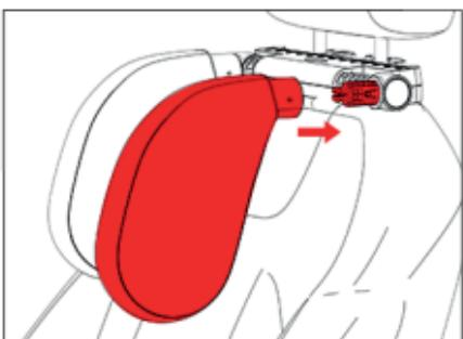
2. Coloque la barra deslizante en una posición adecuada y fíjeza a la barra del reposa cabezas. Instale estos dos soportes laterales.
