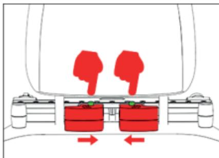
3. Odstráňte dve bočné podpery. Vysuňte posuvnú tyč.
