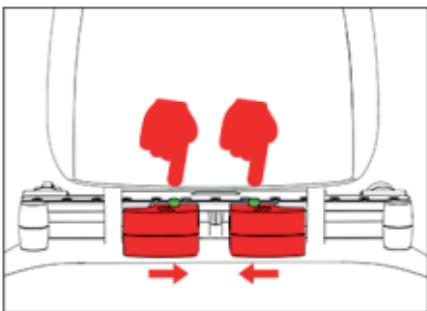
3. Retire los dos soportes laterales. Deslice hacia fuera la barra de deslizamiento.
