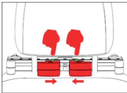
3. Снимите две боковые опоры. Выдвиньте выдвижной стержень.
