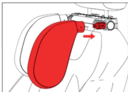
2. Ρυθμίστε τη συρόμενη ράβδο σε κατάλληλη θέση και τοποθετήστε την στη ράβδο του προσκέφαλου. Τοποθετήστε δύο πλευρικά στηρίγματα.
